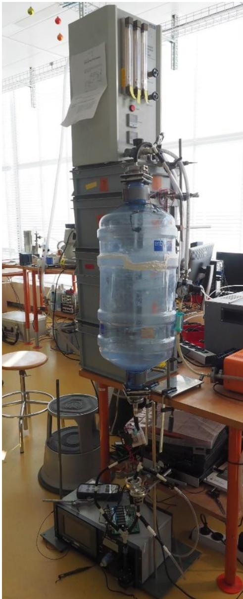
Abbildung 3: Messaufbau für die Abschätzung der Filtereffizienz
